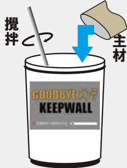
③硬さを調節しながら残りの水道水を少しづつ入れながら攪拌します。
