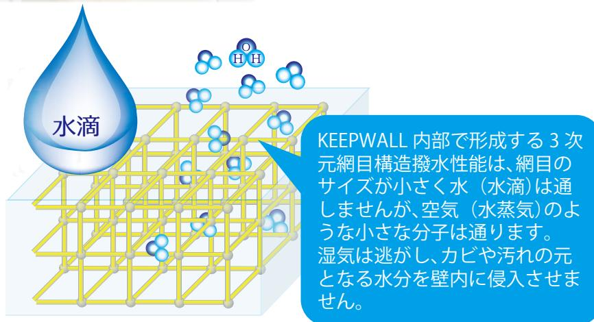
KEEPWALL 内部で形成する 3 次元網目構造撥水性能は、網目のサイズが小さく水（水滴）は通しませんが、空気（水蒸気）のような小さな分子は通ります。湿気は逃がし、カビや汚れの元となる水分を壁内に侵入させません。
