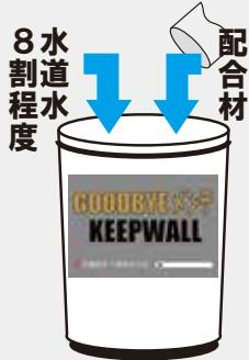
②主材を入れ攪拌します。ダマにならないよう固練りで十分混ぜます。
