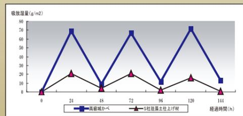
測定条件：25℃の恒温恒湿槽中で、湿度50%RHと90%RHの繰り返し試験（24h毎）3サイクル
